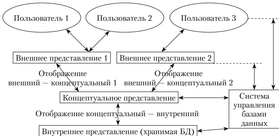
Рис. 2.1. Схематическое представление архитектуры ANSI/SPARC
